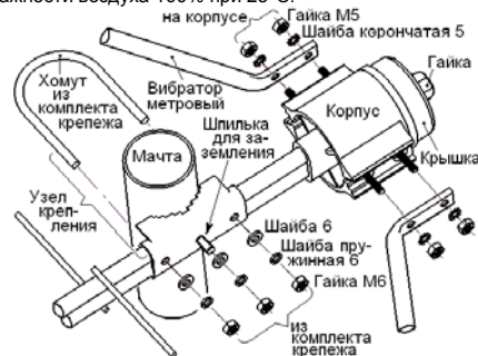
Рисунок 2 - Сборка антенны
