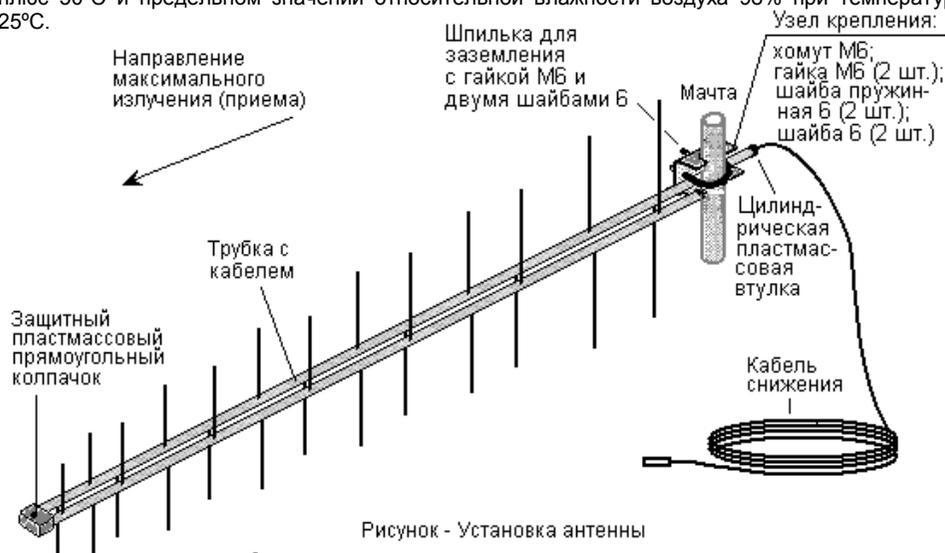
Рисунок - Установка антенны
