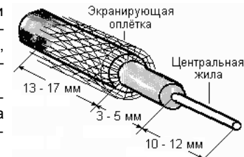
Рисунок 7 - Разделка конца кабеля
