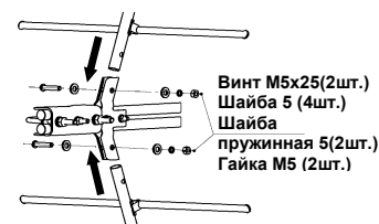
Рисунок 3 – Сборка антенны
